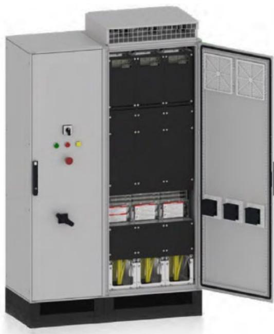
Ячейки объединяются для параллельной работы. Параллельная работа реализована через высокоскоростной цифровой интерфейс и выходные согласующие  $du/dt$  дроссели. Наличие в каждой ячейке входного сетевого дросселя обеспечивает пониженный коэффициент искажений выходного тока.
